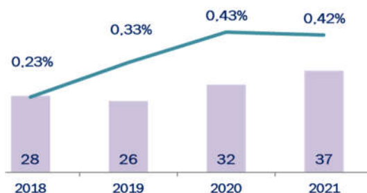
Nombre et taux d'incidents de nature "dommages aux ouvrages" enterrés liés à des travaux de tiers-ensemble des 5 concessions
