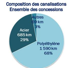
Le réseau de gaz naturel est composé majoritairement (68 %) de canalisations **en polyéthylène** et pour 29 % de canalisations en acier. Le reste (3 %) est composé de fonte, de cuivre, etc.
