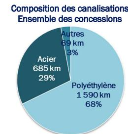
Le réseau de gaz naturel est composé majoritairement (68 %) de canalisations **en polyéthylène** et pour 29 % de canalisations en acier. Le reste (3 %) est composé de fonte, de cuivre, etc.
