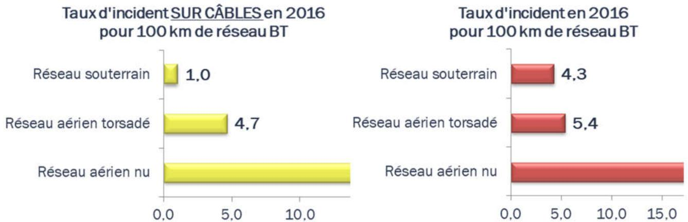
En 2016, le réseau basse tension en fil nu subit 4 fois plus d'incidents que le réseau aérien en torsadé. Compte tenu de ce caractère incidentogène, le SDEC ÉNERGIE s'est engagé à résorber pour 2020, le réseau BT en fils nus pour les communes rurales où il est le principal maître d'ouvrage. Un effort équivalent est demandé à Enedis, maître d'ouvrage pour les communes urbaines.
